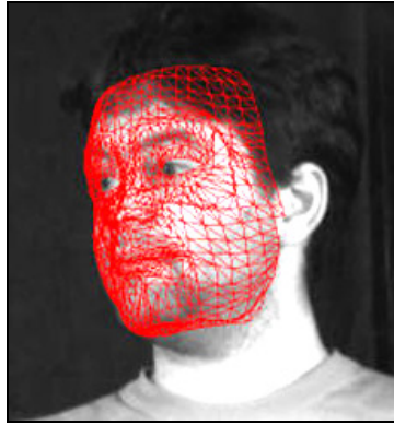
Abbildung 1-2: 3D-Face-Tracking mit deformierbarer Maske bei [5]
